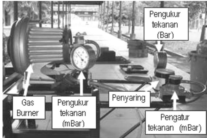
**Gambar 5. Rangkaian Sistem Gas *Burner***
