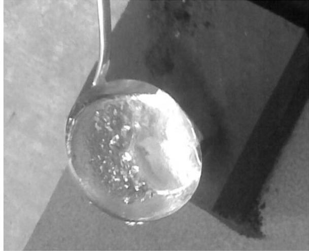
**Gambar 7. Penuangan Aluminium Cair ke dalam Cetakan**
